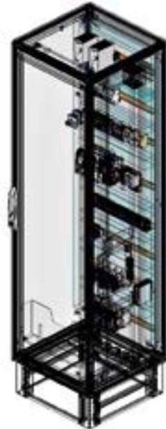
Schaltschranke Sie werden bei Schaeffler mithilfe von Eplan Pro Panel dreidimensional geplant.
